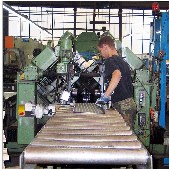
In Sulz werden Blechprofilroste produziert.
